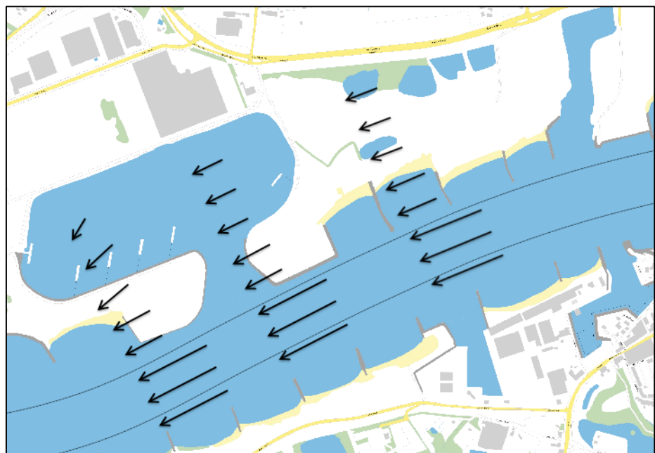
Afbeelding 4. Stroming bij de invaartopening gedurende maatgevend hoogwater (0% van de tijd)
