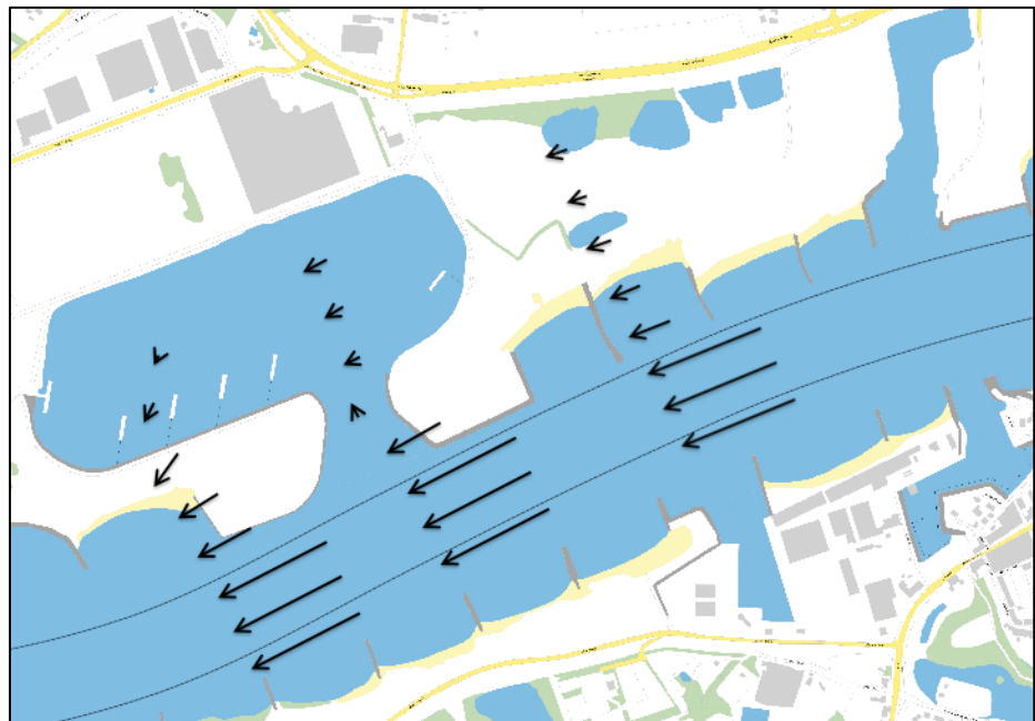
Afbeelding 3. Stroming invaaropening normaal hoogwater (5% van de tijd)
